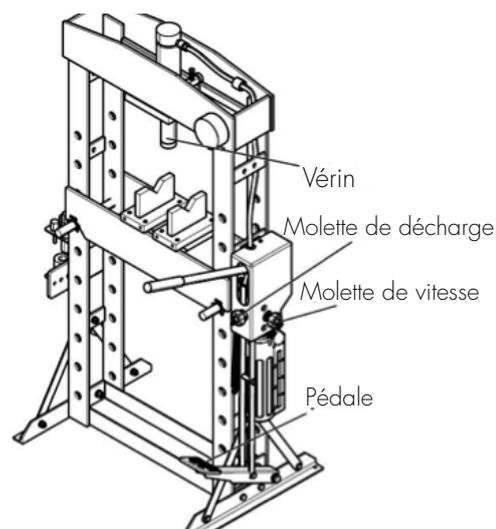
2. Suivre les opérations suivantes pour évacuer l'air du système hydraulique, lorsque la vitesse lente ne fonctionne pas ou que la pression ne monte pas lors de l'utilisation (en particulier pour la première utilisation).
